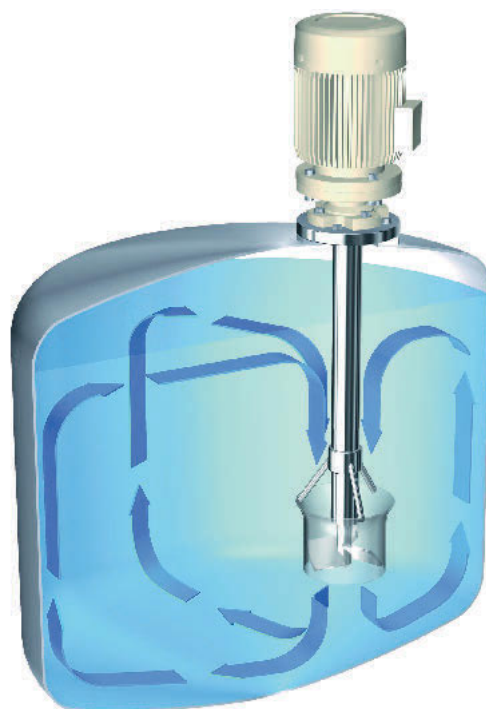
Der Stator verhindert, dass die umgebende Flüssigkeit in Rotation gerät. Gleichzeitig richtet er den Flüssigkeitsstrom direkt auf den Behälterboden.
