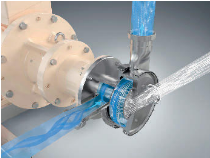
Pulver und Flüssigkeit treffen in der Dispergierzone aufeinander
