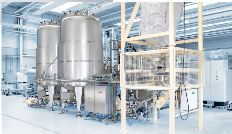
Eine Conti-TDS mit zwei Prozessbehältern: Pulver in Flüssigkeiten wird unter Nutzung eines intern erzeugten Vakuums eingesaugt, benetzt und agglomeratfrei in der Flüssigkeit dispergiert
