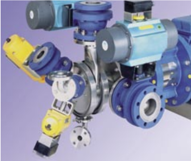
Conti-TDS-Mischkopf mit Flüssigein- und -auslass sowie Pulvereinlässen.
