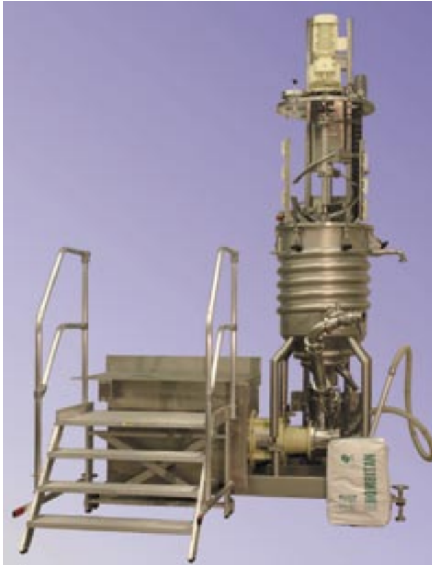
Conti-TDS-Anlage zur Herstellung von hochviskosen Produkten.
