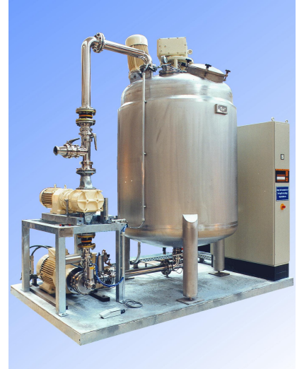
Abb. 4: Conti-TDS mit nachgeschalteter Verdrängerpumpe zur Herstellung hochviskoser Dichtmassen
