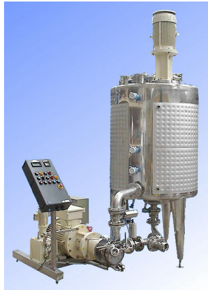
Abb. 8: ystral Conti-TDS in einer Anlage für stark variierende Batchgrößen
