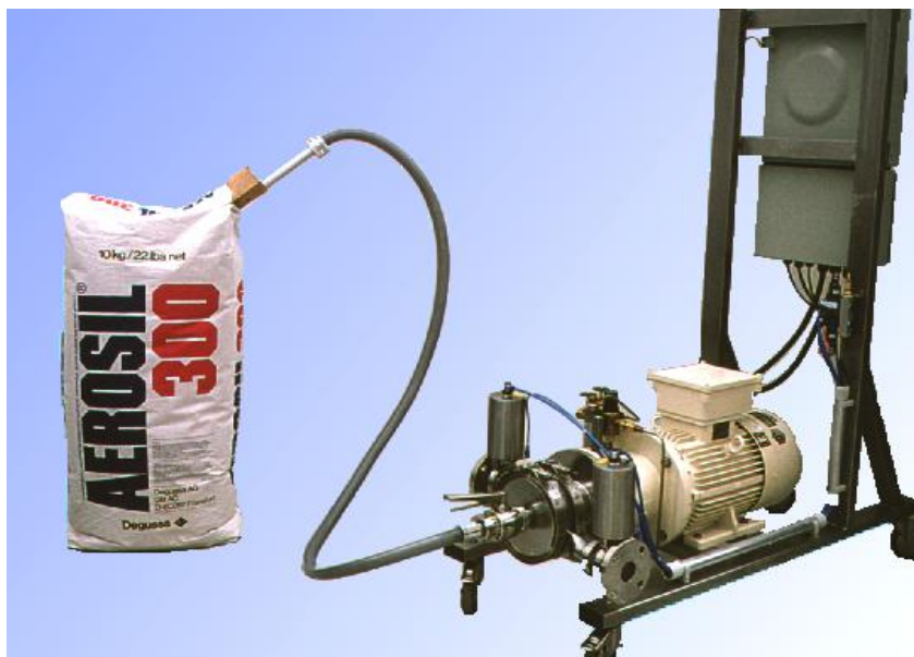
Abb. 3: ystral Conti-TDS mit Saugrohr zum staubfreien Eintrag stark staubender Pulver
