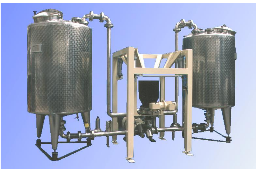
Abb. 1: ystral Conti-TDS mit Big-Bag-Station zwischen zwei Prozessbehältern
