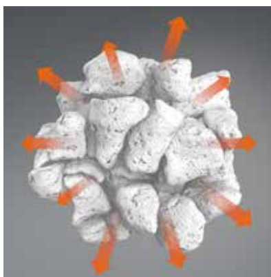
SOTTOVUOTO, L'ARIA CONTENUTA NELLA POLVERE SI ESPANDE
