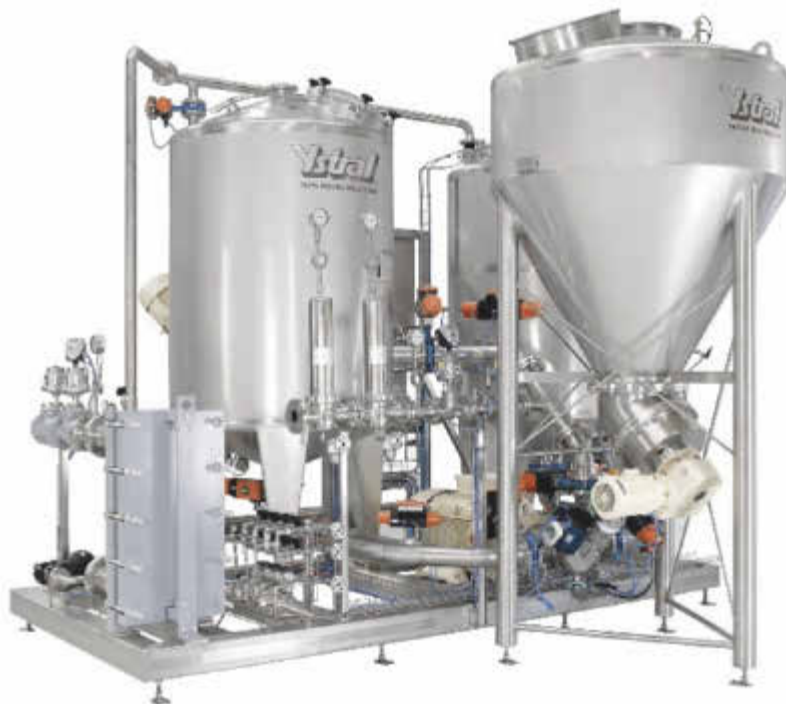
Prozessanlage mit der Conti-TDS, zwei Prozessbehältern und einem Pulverbehälter
